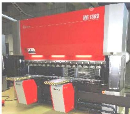
機械前面に設置して、ワークサポートの役割をします。ワークを支える必要がなくなる為、特に重たいワークでは曲げ加工中を通して作業者の疲労軽減になります。また、不意なワークの跳ね上げにより顔などを負傷する危険を低減します。
