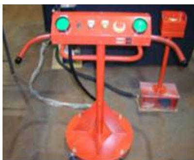
両手操作押釦を備えたスタンドタイプの操作装置です。刃間が材料の上(6mm)に接近するまで両手で操作します。その後、材料を供給し、フットペダルに切替えて曲げを継続します。刃間位置より離れた所で両手を使い作業するため、手が挟まれる危険を低減します。
